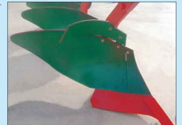
Geschlossener Körper A-9 mit Strohleitblech oder Streifenkörper B mit großem Maiseinleger!
