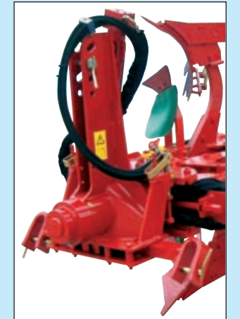
Stabiler Turm mit beweglicher Tragachse und Unterlenkertaschen! Leichte Einstellung der Vorderfurche über das Schlittensystem!
