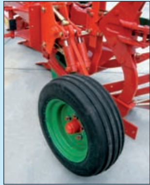
Stützrad 606 x 205 mit hydraulischem Stoßdämpfer oder Transportrad 686 x 260!
