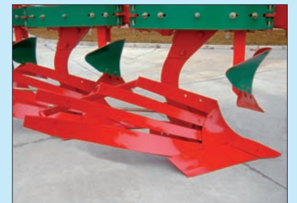
Geschlossener Körper A-9 mit Strohleitblech oder Streifenkörper B mit großem Maiseinleger!
