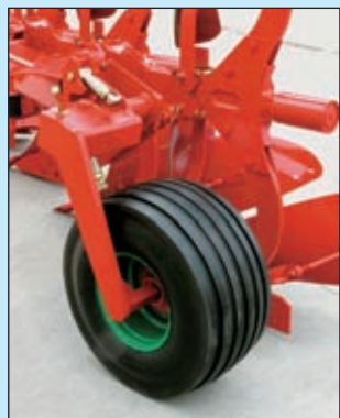
Stützrad 606 x 205 mit hydraulischem Stoßdämpfer oder Transportrad 686 x 260!
