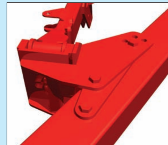
Geschlossener Körper A-9 mit Strohleitblech oder Streifenkörper B mit großem Maiseinleger!
