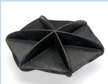
Der Hexa-Cover Schwimmkörper ist 228 mm groß (diagonal) 70 mm hoch 28 Stück/m<sup>2</sup> Gewicht 243 g und besteht zu 100 % aus Polypropylen. Die Lebensdauer beträgt ca. 25 Jahre. Die Schwimmkörper werden in Big Bags angeliefert. Einfach in den Behälter schütten, sie organisieren sich
